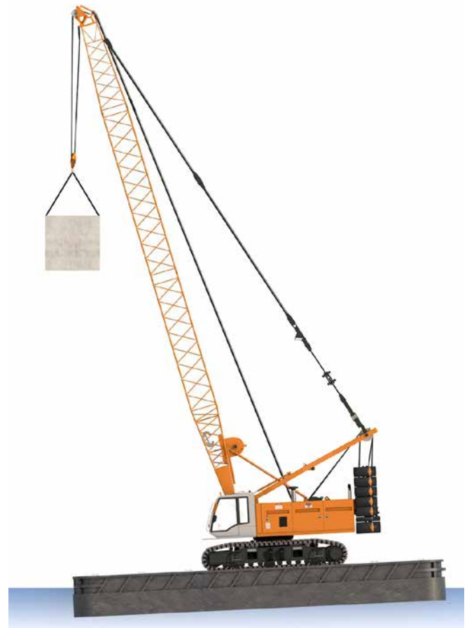
Abb. 145 Seilbagger auf Ponton mit Krängung
