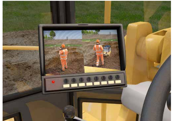
Abb. 74 Splitscreen-Monitor für Rückraum- und Seitenkamera
