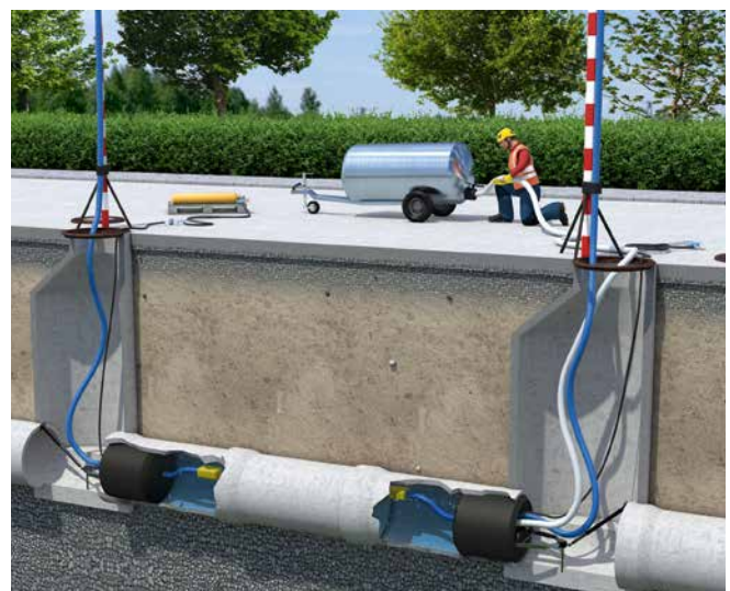
Abb. 119 Durchführung einer Wasserdruckprüfung
