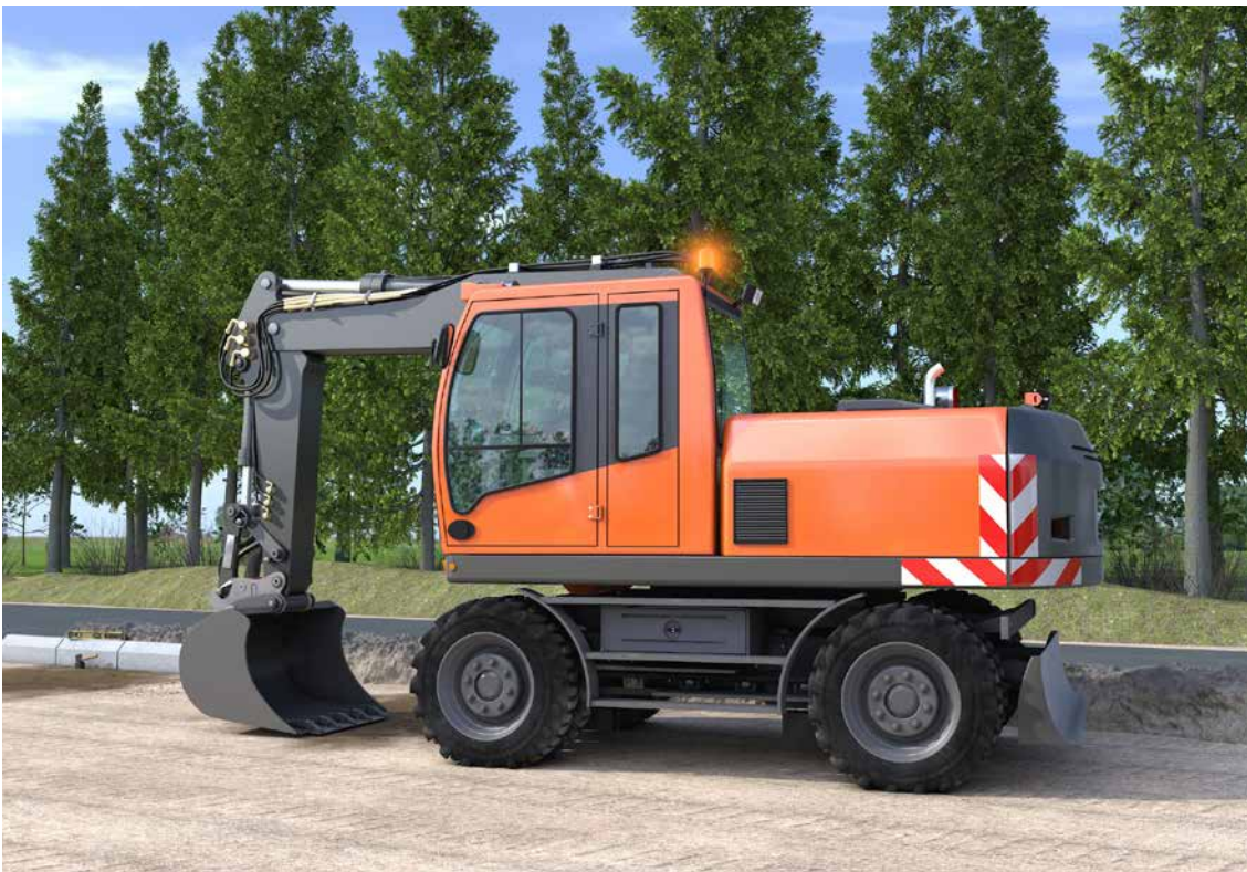
Abb. 67 Sicherheitskennzeichnung und gelbe Rundumleuchte an mobilen Baumaschinen
