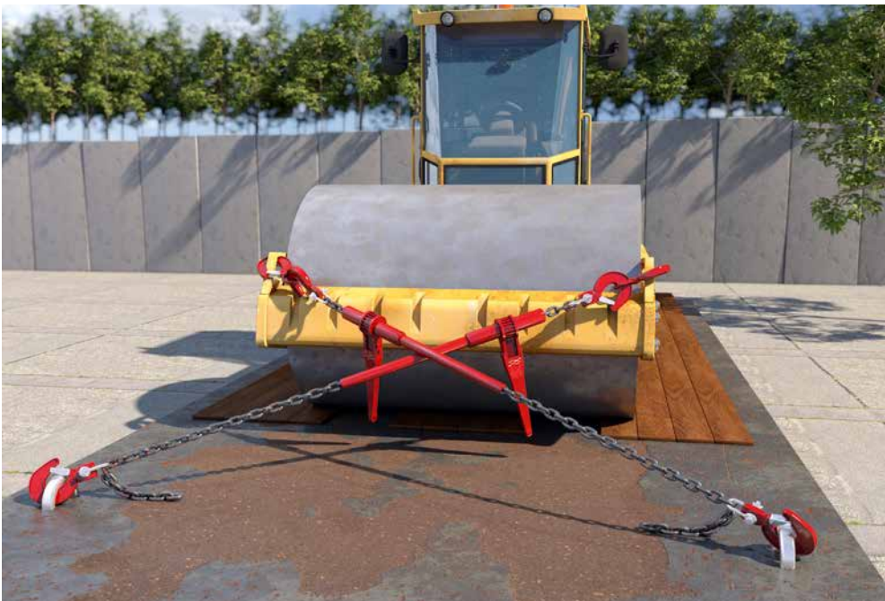
Abb. 85 Mittels Diagonalzurrung gesicherter Walzenzug
