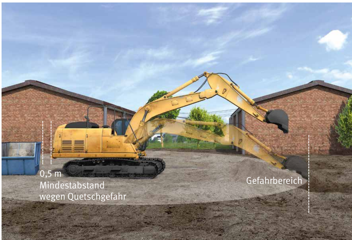
Abb. 72 Gefahrbereich und Quetschstelle beim Betrieb von Erdbaumaschinen
