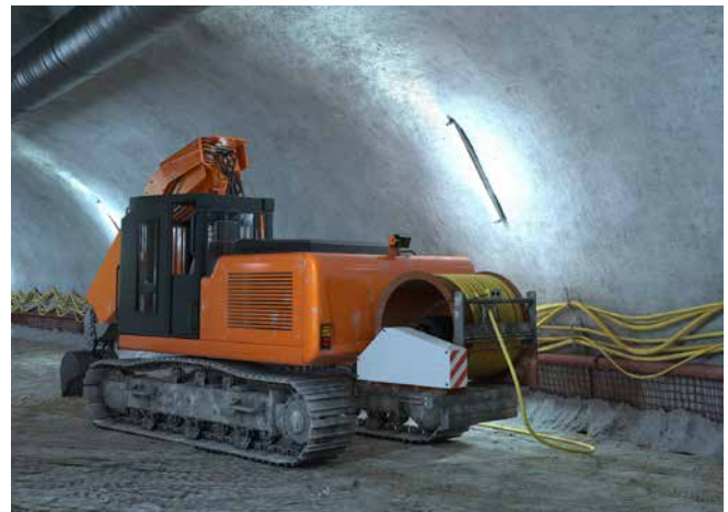
Abb. 143 Bagger mit Elektroantrieb
