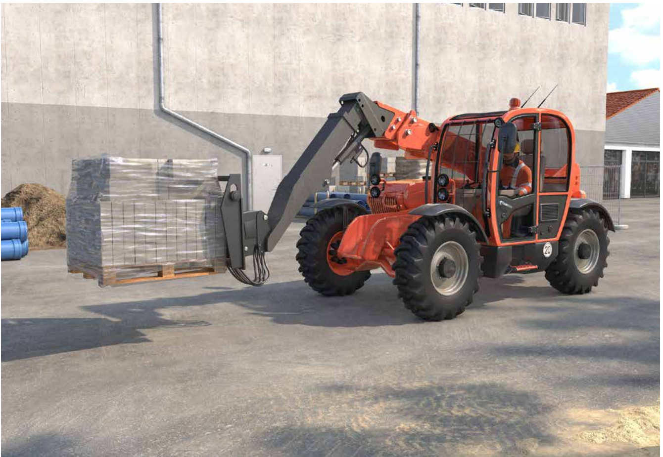
Abb. 60 Sicherer bodennaher Lastentransport
