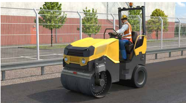
Abb. 101 Bei Umsturzgefahr Überrollschutzeinrichtung und Sicherheitsgurt benutzen
