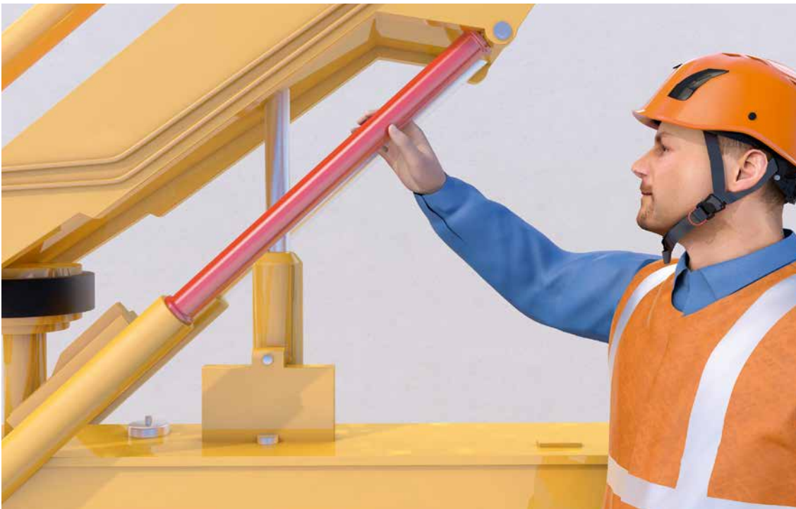
Abb. 94 Formschlüssige Sicherung des Hubgerüsts durch Abstützmanschette
