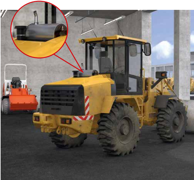
Abb. 95 Nachträglich montierter DPF ohne Beeinträchtigung der Sicht
