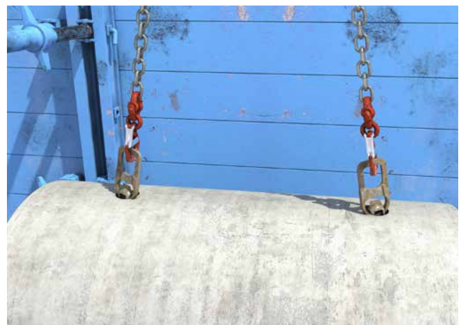
Abb. 87 Formschlüssig wirkende Lastaufnahmemittel (Kugelkopfanke)
